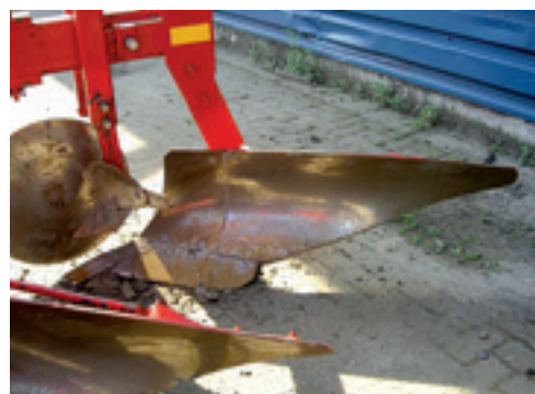
Een gebruikte ploeg kan behoorlijk versleten zijn. Let dan ook op de slijtdelen zoals risters, zoolijzers en voorscharen.
