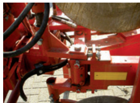
Controleer of alles goed vast zit en let op eventuele scheuren in de ploegbalk, de kop en de lichamen.
